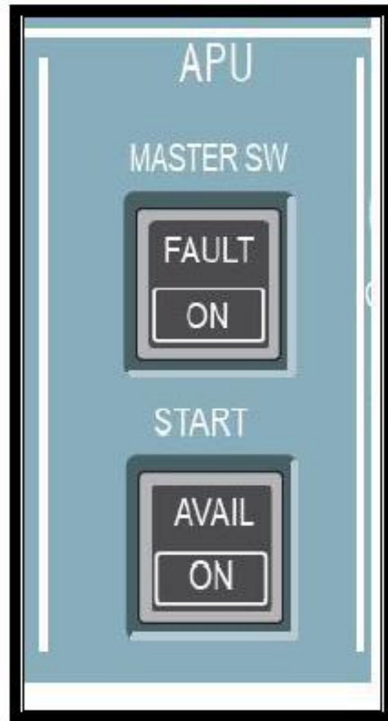
Resim 4.20: APU kontrol paneli
