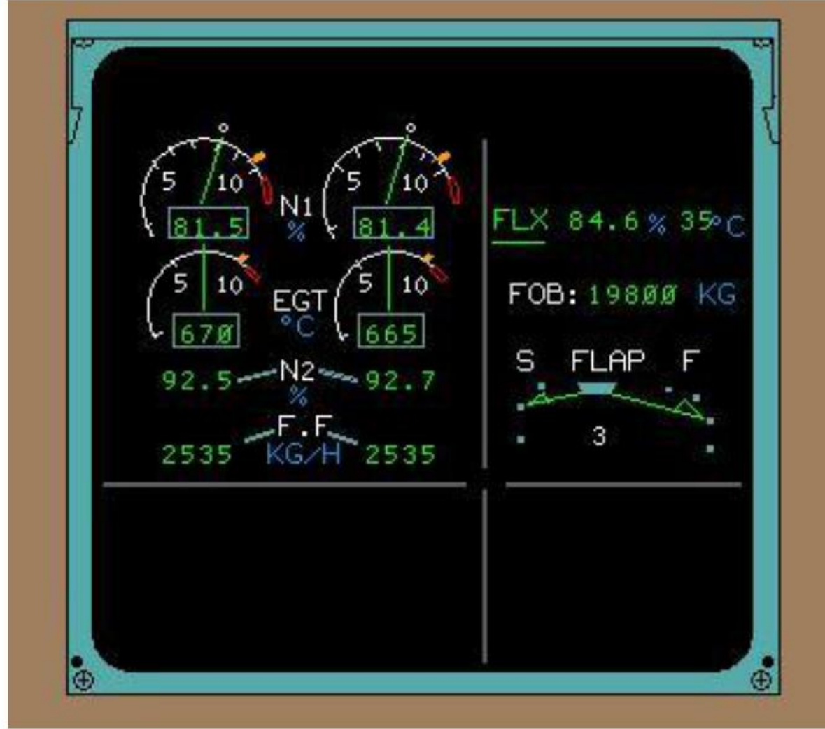
Resim 4.8: Motor uyarı göstergesi üst kısım verileri
