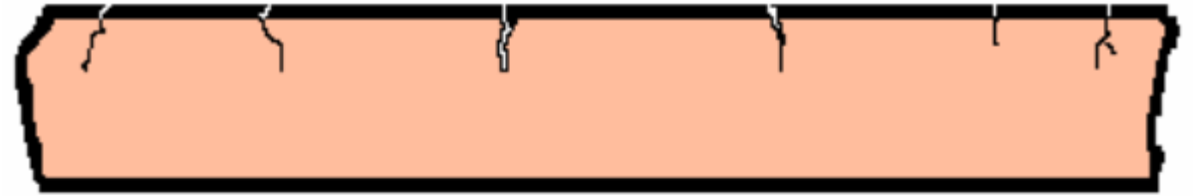
Şekil 1.1: Yüzeğe açık süreksizlik
